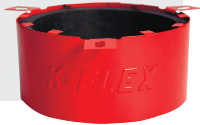
Используются в местах прохождения кабельных проходок, и труб через перегородки и перекрытия. Состоит из разъемного металлического корпуса и вкладыша из терморасширяющегося материала.
